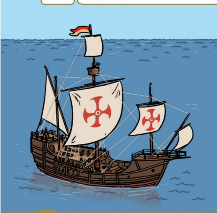
**C**e bateau portugais a une coque haute et un faible tirant d'eau. Il permet les voyages en haute mer et sur les côtes. Il est utilisé pour la découverte de l'Amérique.
